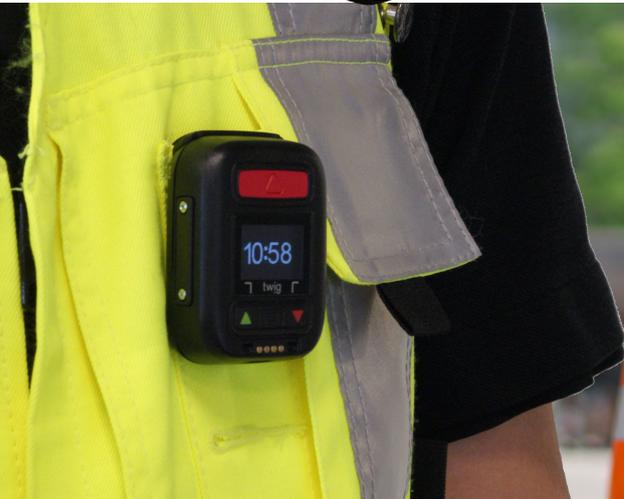
Die bevorzugte Wahl von Wartungsarbeitern ist das Tragen des TWIG Neo am Gürtel oder in der Tasche, sicher befestigt mit einem Gürtelclip.
